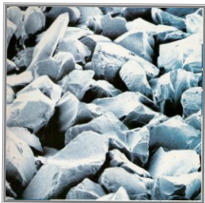
SG brúsne zrná, zväčšenie 50x
