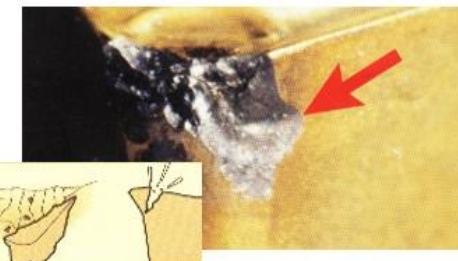
Krehké porušenie rezného klína
